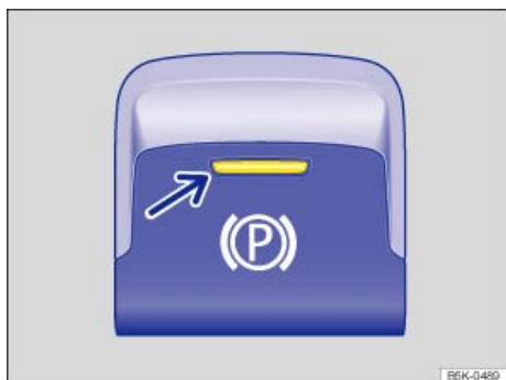
Fig. 177 En la parte inferior de la consola central: tecla del freno de estacionamiento electrónico.
