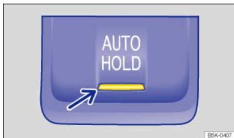
Fig. 181 En la parte inferior de la consola central: tecla de la función Auto Hold.
