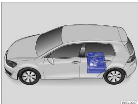
Fig. 36 En el piso del vehículo: ubicación de la batería de alto voltaje.
