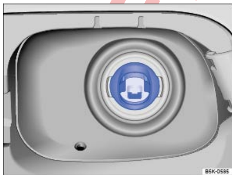
Fig. 235 Tapa del depósito abierta: protección en la boca de carga para no repostar equivocadamente.
