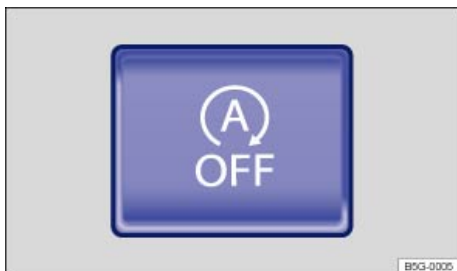
Fig. 182 En la parte inferior de la consola central: tecla del sistema Start-Stop.
