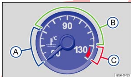
Fig. 240 Indicador de la temperatura del líquido refrigerante del motor: (A) zona fría; (B) zona normal; (C) zona de advertencia.
