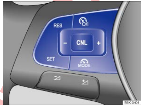
Fig. 199 Lado izquierdo del volante multifunción: teclas para manejar el GRA.
