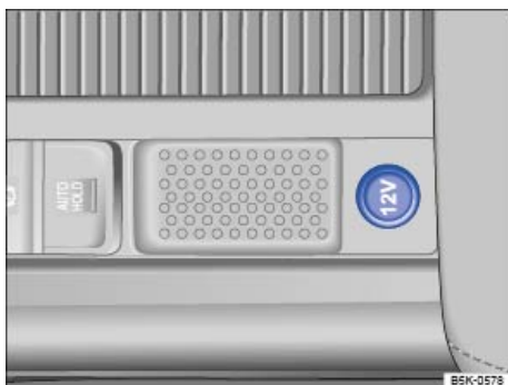
Fig. 162 En la parte inferior de la consola central: toma de corriente de 12 voltios.
