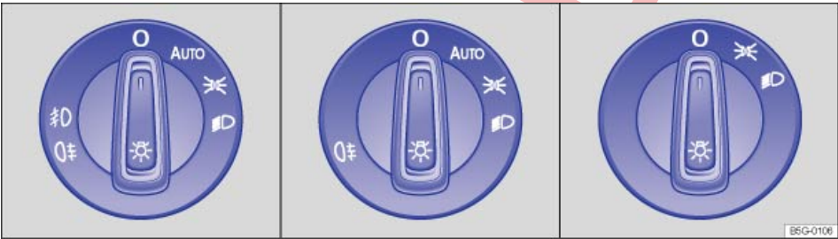
Fig. 119 Junto al volante: representación de algunos tipos de mandos de luces.
