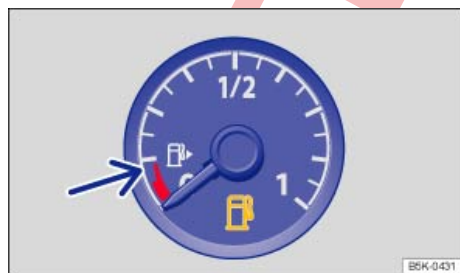
Fig. 231 En el cuadro de instrumentos: indicador del nivel de combustible para gasolina y gasóleo.
