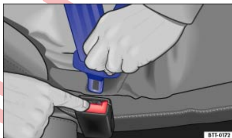
Fig. 102 Soltar la lengüeta del cierre del cinturón.
