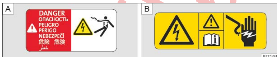
Fig. 22 Letreros de advertencia, variante 1: (representaciones esquemáticas): A) Componentes de alto voltaje; B) Letrero de advertencia general de alto voltaje.
