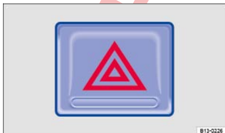
Fig. 255 En la parte superior de la consola central: pulsador de los intermitentes de emergencia.
