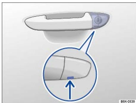
Fig. 257 Manilla de la puerta del conductor: bombín de la cerradura cubierto.
