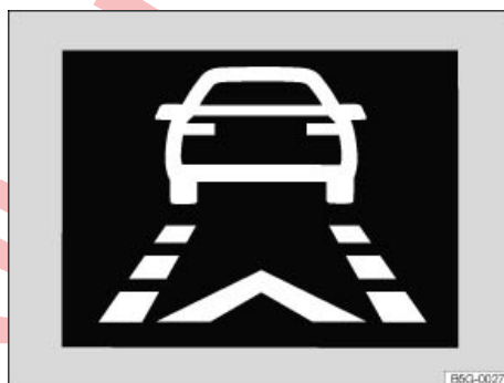
Fig. 211 En la pantalla del cuadro de instrumentos: indicación del preaviso.
