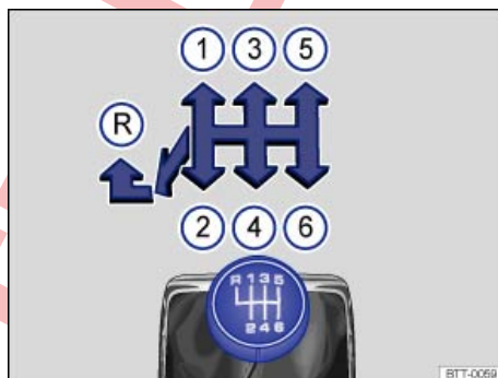
Fig. 171 Esquema de un cambio manual de 6 marchas.
