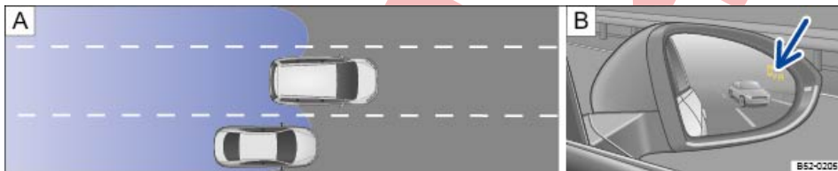
Fig. 220 Representación esquemática: A Situación en un adelantamiento e incorporación posterior al carril derecho. B Indicación del asistente de ángulo muerto en el retrovisor exterior derecho.
