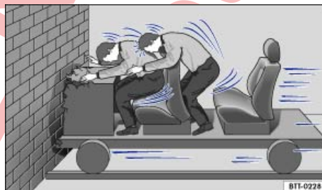
Fig. 97 El vehículo choca contra el muro. Los ocupantes no llevan colocado el cinturón de seguridad.
