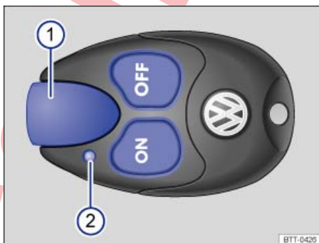
Fig. 229 Calefacción independiente: mando a distancia por radiofrecuencia.
