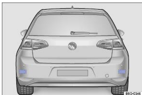
Fig. 218 Vista trasera del vehículo: zonas de los sensores de radar.
