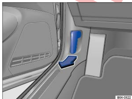
Fig. 236 En la zona reposapiés del lado del conductor: palanca de desbloqueo del capó del motor.
