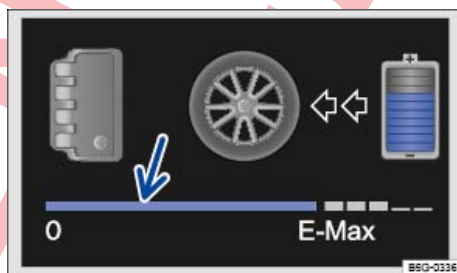
Fig. 26 Pantalla del cuadro de instrumentos: representación esquemática de la indicación de la potencia eléctrica disponible.
