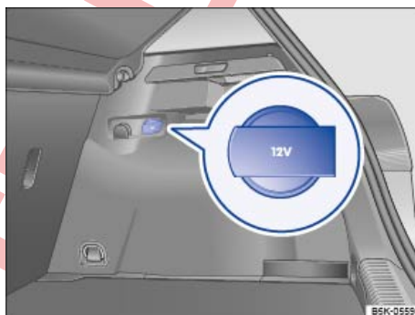
Fig. 163 En el maletero: toma de corriente de 12 voltios.
