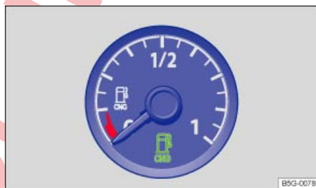
Fig. 232 En el cuadro de instrumentos: indicador del nivel de gas natural.
