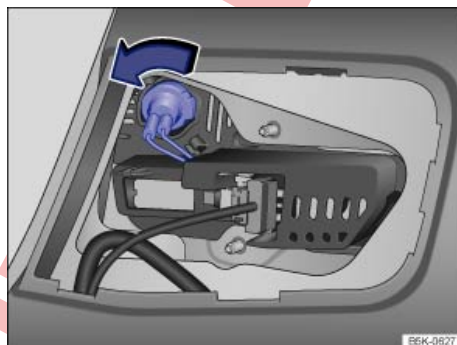
Fig. 291 En el portón trasero: extraer el portalámparas.
