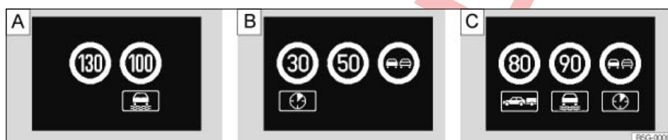
Fig. 222 En la pantalla del cuadro de instrumentos: ejemplos de limitaciones de velocidad o prohibiciones de adelantamiento reconocidas con sus respectivos paneles complementarios.
