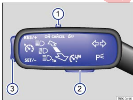
Fig. 201 En el lado izquierdo de la columna de dirección: mando y teclas para manejar el limitador de velocidad.
