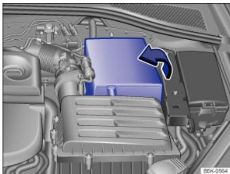
Fig. 243 En el vano motor: levantar la cubierta guardapolvo de la batería de 12 voltios.
