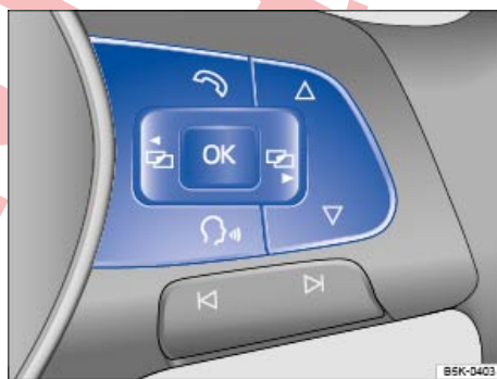
Fig. 17 Lado derecho del volante multifunción: teclas para utilizar los menús y las indicaciones informativas del cuadro de instrumentos.
