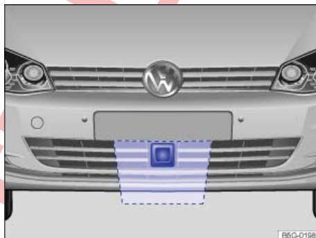
Fig. 206 Zona que hay que dejar libre alrededor del sensor de radar.
