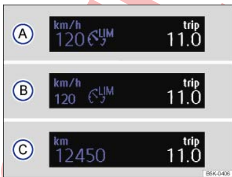
Fig. 200 En la pantalla del cuadro de instrumentos: indicaciones del estado del limitador de velocidad.
