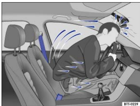
Fig. 98 El conductor sin el cinturón de seguridad colocado sale lanzado hacia delante.
