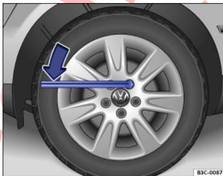
Fig. 270 Cambio de rueda: aflojar los tornillos de rueda.
