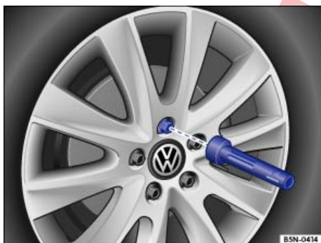
Fig. 277 Cambio de rueda: desenroscar los tornillos de rueda con el mango del destornillador.
