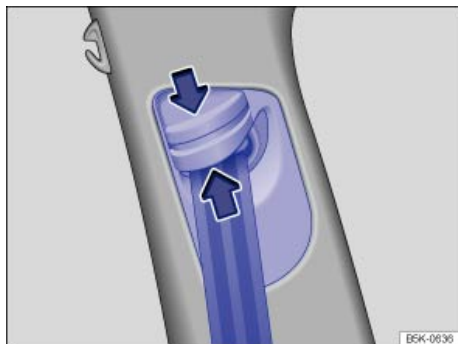
Fig. 105 Junto a los asientos delanteros: regulador de la altura del cinturón.
