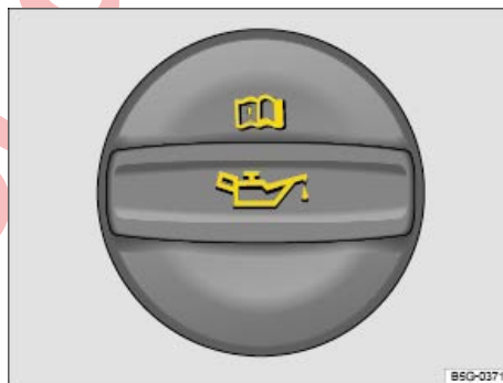
Fig. 239 En el vano motor: tapa de la boca de llenado de aceite.
