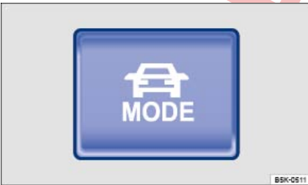
Fig. 224 En la parte inferior de la consola central: tecla para la selección del perfil de conducción.
