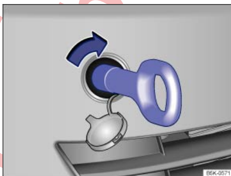
Fig. 300 En el lado derecho del paragolpes delantero: enroscar la argolla de remolque.
