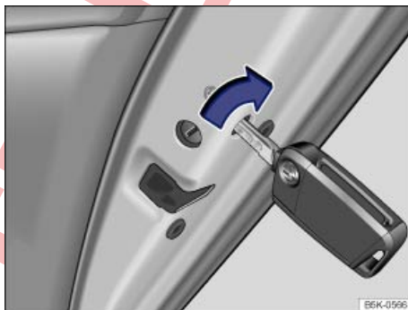
Fig. 259 En el frontal de la puerta trasera derecha: bloqueo de emergencia del vehículo con la llave del vehículo.
