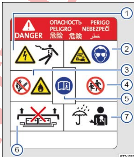
Fig. 37 Letrero de advertencia de la batería de alto voltaje.
