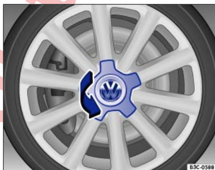
Fig. 267 Desenroscar el tapacubos central.
