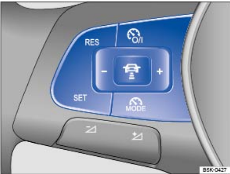
Fig. 207 Lado izquierdo del volante multifunción: teclas para manejar el control de crucero adaptativo.
