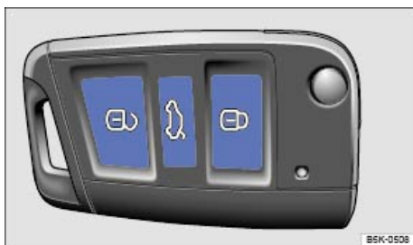
Fig. 62 Teclas en la llave del vehículo.
