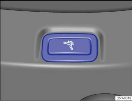
Fig. 92 En la parte inferior del asiento del conductor: tecla de la función de masaje lumbar.
