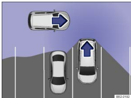
Fig. 221 Representación esquemática del asistente de desaparcamiento: zona vigilada alrededor del vehículo que está desaparcando.
