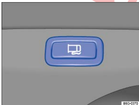
Fig. 34 En la puerta del conductor: tecla de desbloqueo de la tapa del depósito de combustible.
