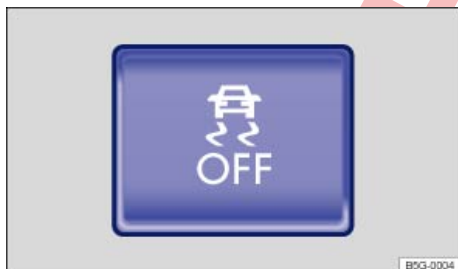
Fig. 178 En la parte inferior de la consola central: tecla para desconectar y conectar manualmente el ASR, el ASR junto con el ESC o el ESC Sport.
