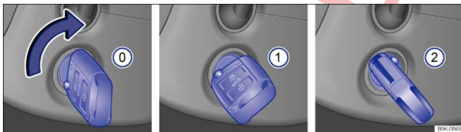
Fig. 164 Posiciones de la llave del vehículo en la cerradura de encendido.
