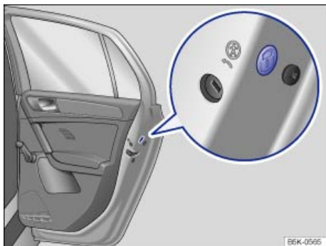
Fig. 258 En el frontal de la puerta trasera derecha: bloqueo de emergencia cubierto por una junta de goma.
