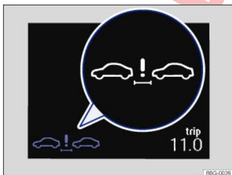
Fig. 210 En la pantalla del cuadro de instrumentos: indicación de advertencia de la distancia.
