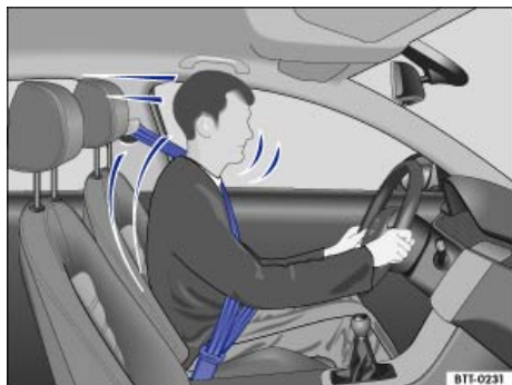
Fig. 100 Los conductores que lleven el cinturón de seguridad correctamente colocado no saldrán lanzados en caso de un frenazo.
