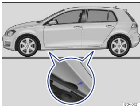
Fig. 274 Puntos de apoyo para el gato.
