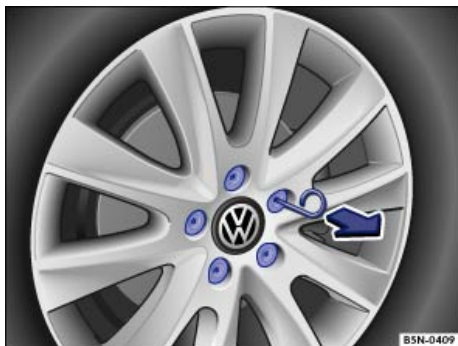
Fig. 269 Quitar los capuchones de los tornillos de rueda.
