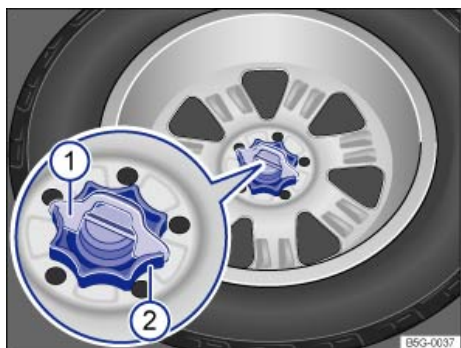
Fig. 251 En el maletero: ruedecilla para fijación de la rueda de repuesto.
