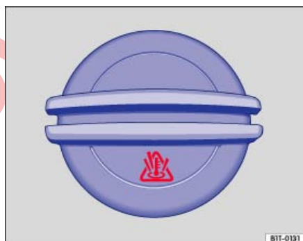
Fig. 242 En el vano motor: tapa del depósito de expansión del líquido refrigerante del motor.
