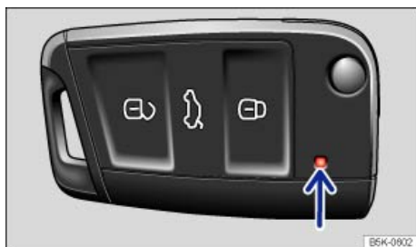
Fig. 59 Testigo de control en la llave del vehículo.
