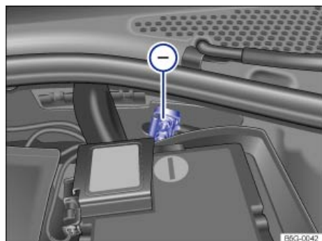
Fig. 296 En el vano motor: toma para la ayuda de arranque (terminal de masa) (-).
