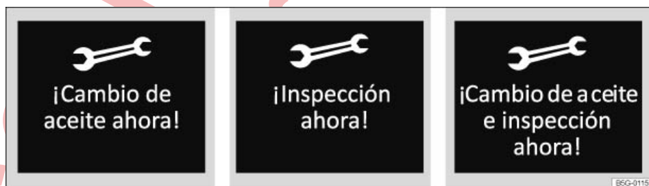
Fig. 14 Representación esquemática: ejemplos de visualización de avisos de servicio en la pantalla del cuadro de instrumentos.
