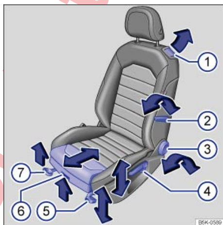
Fig. 79 Mandos del asiento delantero izquierdo (variante 2).
