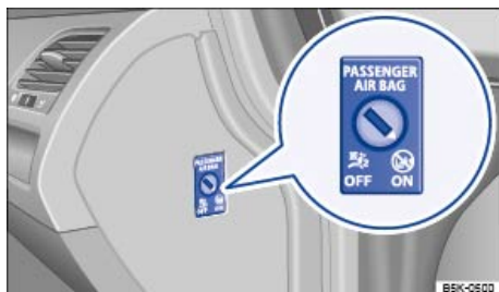
Fig. 109 En el tablero de instrumentos del lado del acompañante: interruptor de llave para activar y desactivar el airbag frontal del acompañante.
