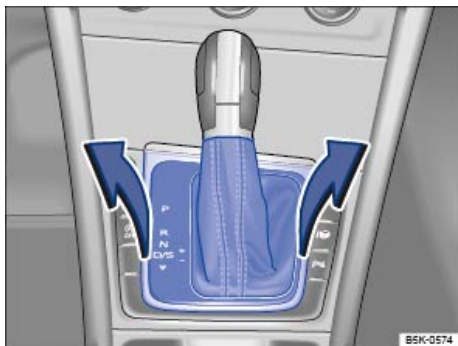
Fig. 262 Desmontar la cubierta de la correa de la palanca selectora.
