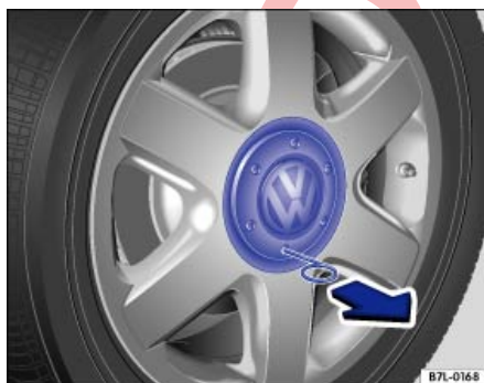
Fig. 266 Desmontar el tapacubos central.
