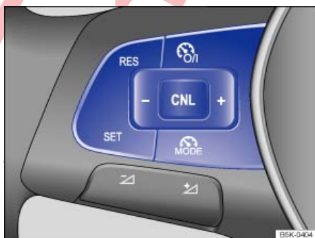
Fig. 202 Lado izquierdo del volante multifunción: teclas para manejar el limitador de velocidad. ►
