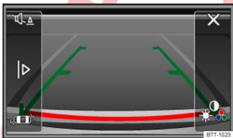
Fig. 191 Visualización en la pantalla del sistema de infotainment: asistente de marcha atrás conectado.
