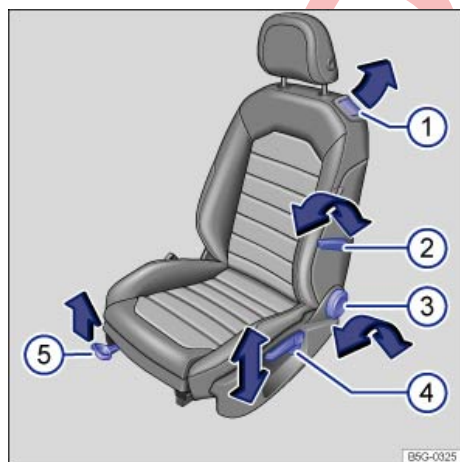
Fig. 78 Mandos del asiento delantero izquierdo (variante 1).
