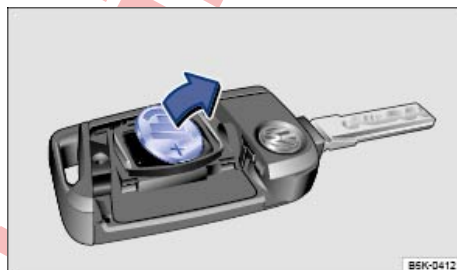
Fig. 61 Llave del vehículo: extraer la pila.
