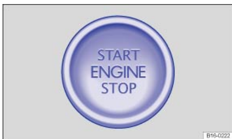
Fig. 165 En la parte inferior de la consola central: pulsador de arranque del sistema de cierre y arranque Keyless Access.
