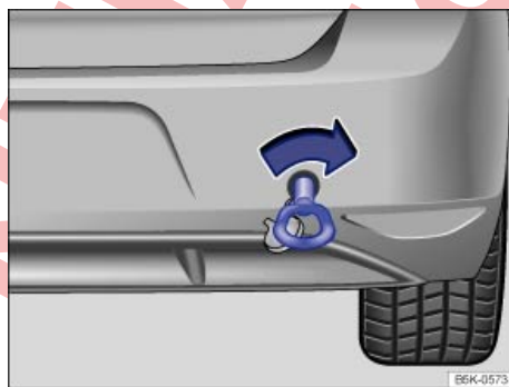
Fig. 302 En el lado derecho del paragolpes trasero: enroscar la argolla de remolque.
