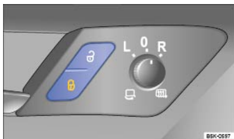
Fig. 64 En la puerta del conductor: tecla del cierre centralizado.
