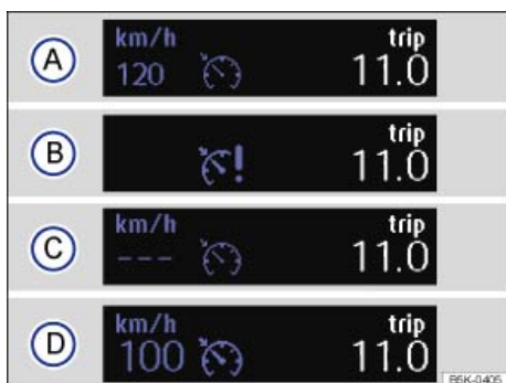
Fig. 197 En la pantalla del cuadro de instrumentos: indicaciones del estado del GRA.
