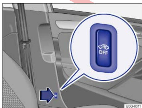
Fig. 67 Junto al asiento del conductor: tecla para desconectar la vigilancia del habitáculo y el sistema antirremolcado.
