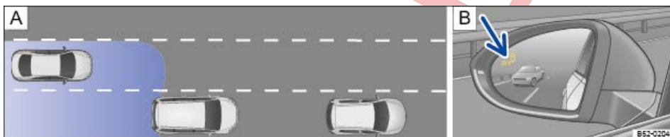
Fig. 219 Representación esquemática: A Situación en un adelantamiento con tráfico en la parte trasera. B Indicación del asistente de ángulo muerto en el retrovisor exterior izquierdo.
