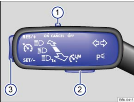
Fig. 198 En el lado izquierdo de la columna de dirección: mando y teclas para manejar el GRA.
