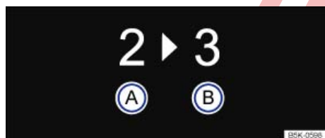
Fig. 176 En la pantalla del cuadro de instrumentos: recomendación de marcha.
