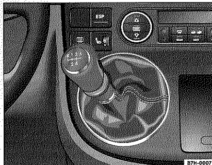
Fig. 97 Palanca con el esquema de un cambio de 5 marchas
