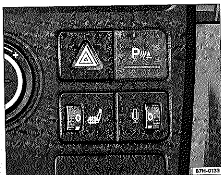
Fig. 103 Detalle del tablero de instrumentos: tecla para activar y desactivar el control de la distancia de aparcamiento
