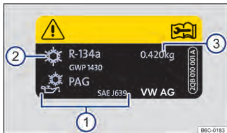
Fig. 227 Información del aire acondicionado
