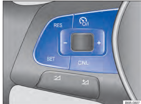
Fig. 103 Lado izquierdo del volante multifunción: teclas para comandar el GRA.
