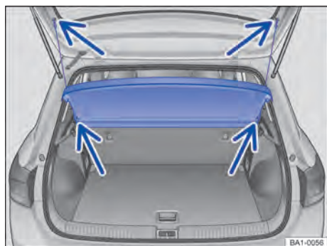
Fig. 173 En el maletero: desmontar y montar la bandeja trasera.
