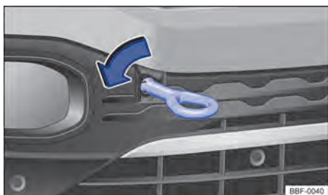
Fig. 199 En el parachoques delantero a la derecha: enrosque la argolla de remolque.
