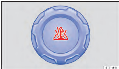
Fig. 207 En el compartimento del motor: tapa del depósito de expansión del líquido refrigerante del motor.
