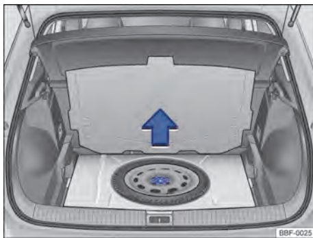
Fig. 179 En el maletero, por debajo del revestimiento del piso: rueda de emergencia y herramientas de a bordo.
