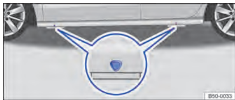
Fig. 219 Puntos de apoyo del gato.
