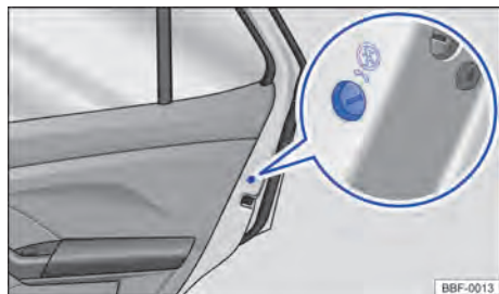
Fig. 44 En la puerta trasera (lado derecho): ubicación del seguro para niños.
