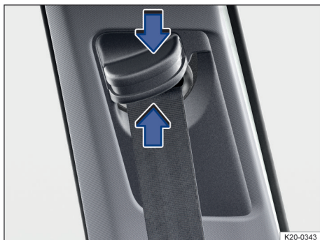
Fig. 24 Junto a los asientos delanteros: regulador de la altura del cinturón.
