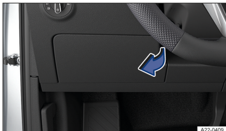
Fig. 148 En el tablero de instrumentos del lado del conductor: tapa de la caja de fusibles (representación esquemática).
