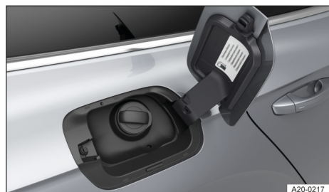
Fig. 137 Detrás de la tapa del depósito de combustible: tapón del depósito (representación esquemática).
