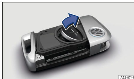
Fig. 41 Llave del vehículo: cambiar la pila de botón.
