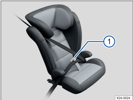
Fig. 30 Asiento para niños con guía adicional del cinturón (representación esquemática).
