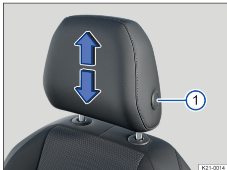
Fig. 59 Desmontaje de los apoyacabezas delanteros (representación esquemática).
