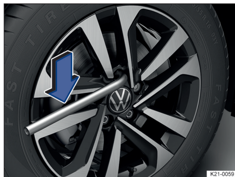
Fig. 181 Aflojar los tornillos de rueda.
