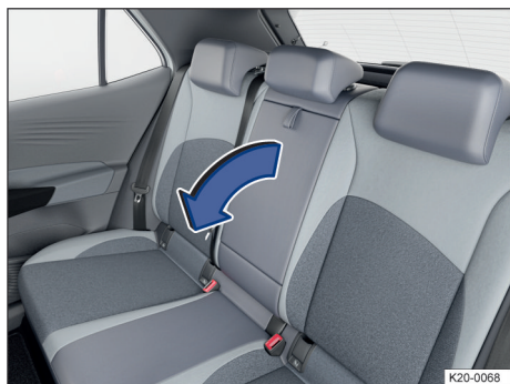
Fig. 65 En el respaldo de la plaza central del asiento: reposabrazos central trasero abatible.
