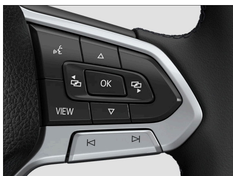
Fig. 12 Lado derecho del volante multifunción: manejo del cuadro de instrumentos digital Basic (representación esquemática).
