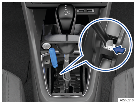
Fig. 87 En la consola central: realizar un desbloqueo de emergencia de la palanca selectora (variante 1).
