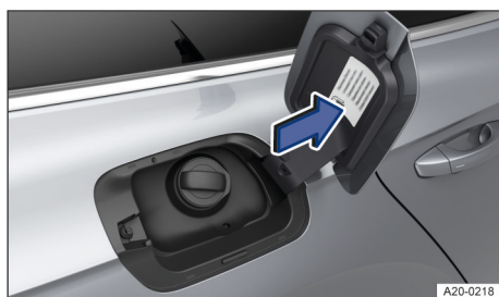
Fig. 132 En la cara interior de la tapa del depósito de combustible: adhesivo del combustible (representación esquemática).
