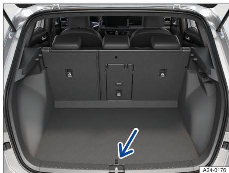
Fig. 123 En el maletero: abrir el piso del maletero.
