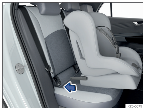
Fig. 33 Montaje de un asiento para niños con conectores (representación esquemática).
