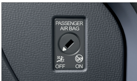
Fig. 26 En el tablero de instrumentos, en el lado del acompañante: conmutador de llave para desactivar y activar el airbag frontal del acompañante.
