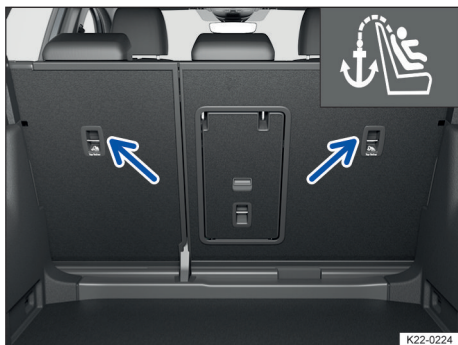
Fig. 34 En la parte posterior de los asientos traseros: anclajes Top Tether para el cinturón de fijación superior Top Tether (representación esquemática).
