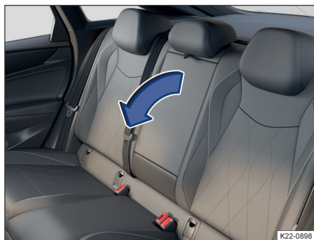
Fig. 116 En el respaldo de la plaza central del asiento: reposabrazos central trasero abatible (representación esquemática).
