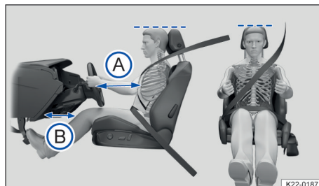
Fig. 19 Distancia correcta entre el conductor y el volante, colocación correcta de la banda del cinturón y ajuste correcto del apoyacabezas (representación esquemática).
