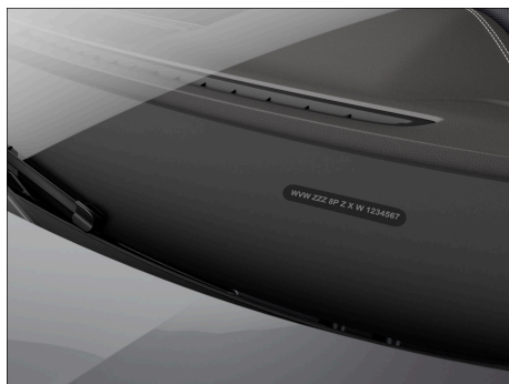
Fig. 260 En el parabrisas: número de identificación del vehículo.
