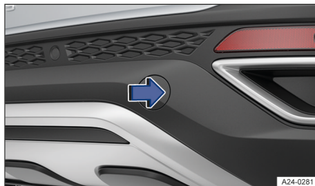
Fig. 157 En el lado derecho del paragolpes trasero: retirar la tapa.
