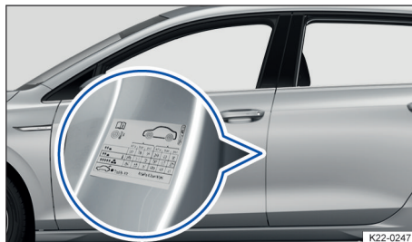
Fig. 173 En el pilar de la puerta del conductor: adhesivo de la presión de los neumáticos (o en la cara interior de la tapa del depósito de combustible).
