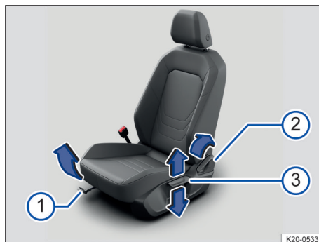
Fig. 55 En el asiento del conductor: mandos.
