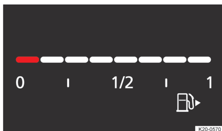
Fig. 14 En el cuadro de instrumentos digital Basic: indicador del nivel de combustible (representación esquemática).
