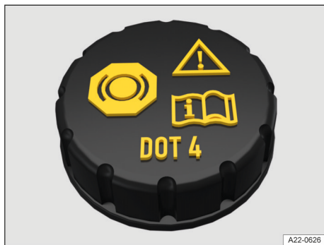
Fig. 171 En el vano delantero: tapa del depósito del líquido de frenos.
