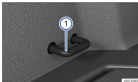
Fig. 124 En el maletero: argollas de amarre (representación esquemática).
