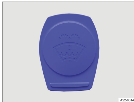
Fig. 164 En el vano delantero: tapa del depósito del líquido lavacristales (representación esquemática).
