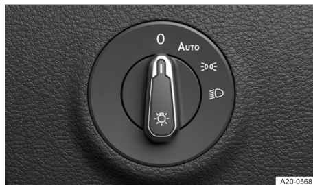
Fig. 67 Junto al volante: mando de las luces.
