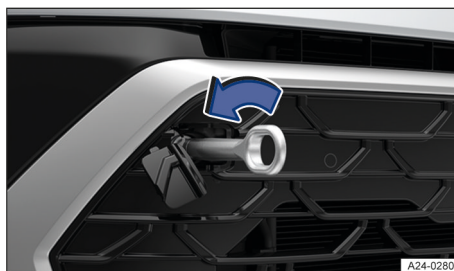
Fig. 156 En el lado derecho del paragolpes delantero: enroscar la argolla de remolque.
