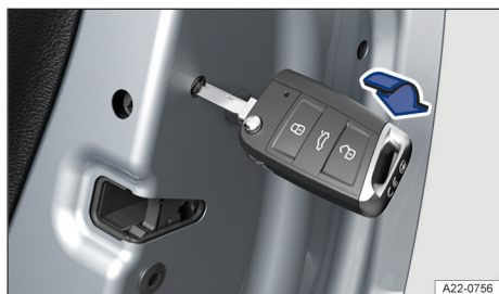
Fig. 46 En el frontal de la puerta trasera: bloqueo de emergencia del vehículo con el paletón de la llave o la llave de emergencia (variante 1).
