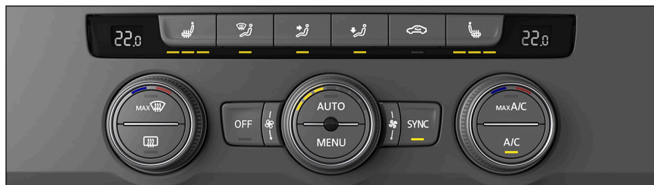
Fig. 79 En la parte superior de la consola central: panel de mandos del Climatronic (variante 2).
