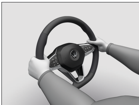
Fig. 54 En el volante: posición equivalente a las 9 y las 3 horas (representación esquemática).
