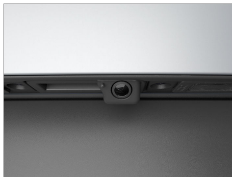
Fig. 189 En la parte trasera del vehículo: cámara de marcha atrás en la manilla con pulsador (representación esquemática).
