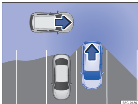
Fig. 114 Zona vigilada alrededor del vehículo que está desaparecando (representación esquemática).
