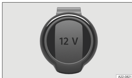
Fig. 118 En el portaobjetos de la parte delantera de la consola central: toma de corriente de 12 voltios con tapa plegable (representación esquemática).
