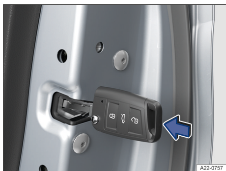
Fig. 47 En el frontal de la puerta trasera: bloqueo de emergencia del vehículo con el paletón de la llave o la llave de emergencia (variante 2).
