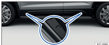
Fig. 182 En el larguero inferior: marcas para los puntos de alojamiento del gato.
