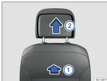
Fig. 61 Desmontaje de los apoyacabezas delanteros (representación esquemática).
