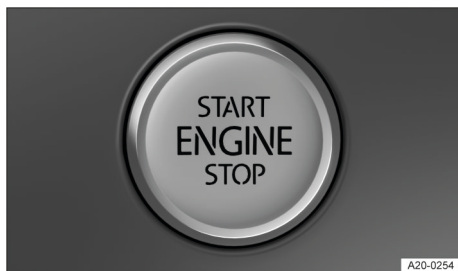
Fig. 81 En la parte inferior de la consola central: pulsador de encendido y arranque.
