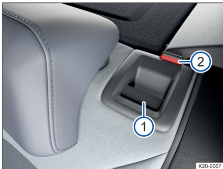
Fig. 58 En el respaldo del asiento trasero: tecla de desbloqueo.
