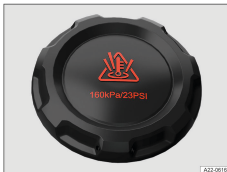
Fig. 169 En el vano delantero: tapa del depósito de expansión del líquido refrigerante (representación esquemática).
