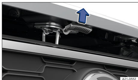
Fig. 160 Encima de la parrilla del radiador: palanca de accionamiento del capó delantero (representación esquemática).
