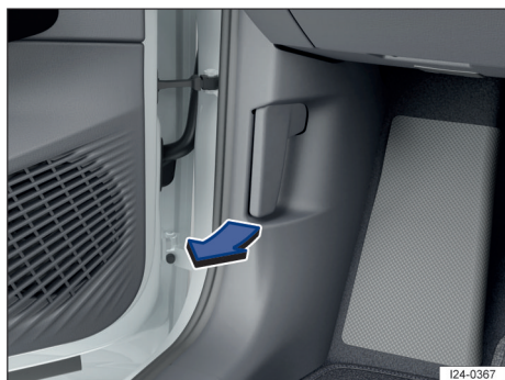
Fig. 159 En la zona reposapiés del lado del conductor: palanca de desbloqueo del capó delantero (representación esquemática).
