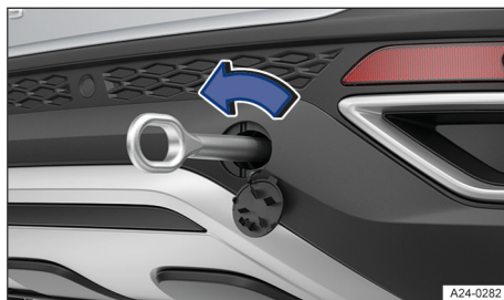
Fig. 158 En el lado derecho del paragolpes trasero: enroscar la argolla de remolque.
