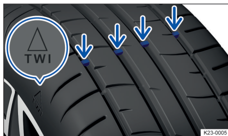
Fig. 178 En las acanaladuras del perfil: indicadores de desgaste.
