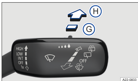
Fig. 71 En el lado derecho de la columna de dirección: manejo del limpiacristales.
