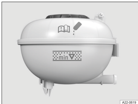
Fig. 170 En el vano delantero: marcas en el depósito de expansión del líquido refrigerante (representación esquemática).
