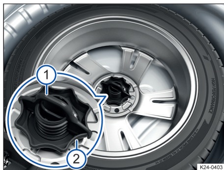
Fig. 179 Debajo del piso del maletero: ruedecilla para fijar la rueda de repuesto o la rueda de emergencia.
