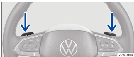
Fig. 86 Detrás del volante: levas de cambio para el Tiptronic (representación esquemática).
