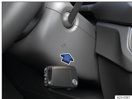
Fig. 82 En el lado derecho de la columna de dirección: función de arranque de emergencia en los vehículos con el sistema de cierre y arranque sin llave "Keyless Access" (representación esquemática).
