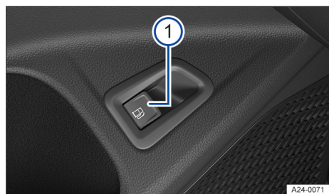
Fig. 138 En la puerta del conductor: tecla de desbloqueo de la tapa del depósito de combustible (representación esquemática).
