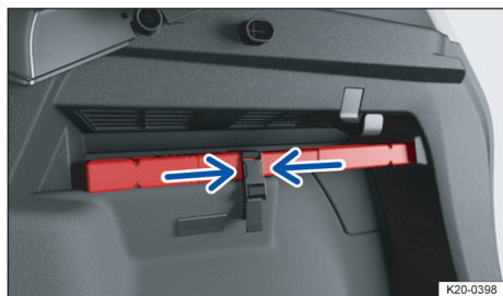
Fig. 36 En el lado derecho del maletero: soporte del triángulo de preseñalización.
