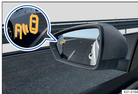
Fig. 106 En los espejos de los retrovisores exteriores: indicación del detector de ángulo muerto.
