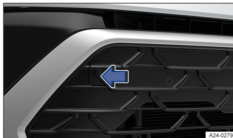
Fig. 155 En el lado derecho del paragolpes delantero: retirar la tapa.
