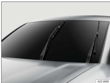
Fig. 142 Limpiacristales en posición de servicio (representación esquemática).
