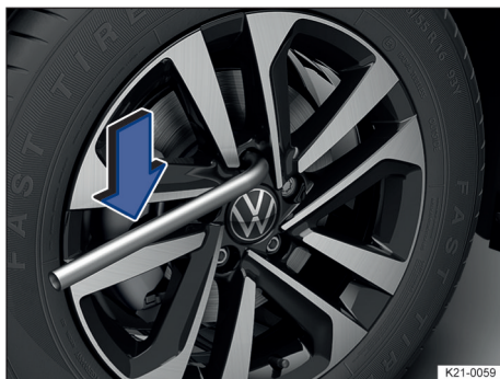
Fig. 185 Desenroscar los tornillos de rueda con la llave de rueda.
