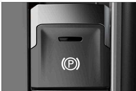
Fig. 107 En la consola central: tecla del freno de estacionamiento electrónico.
