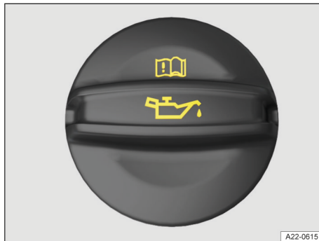
Fig. 167 En el vano delantero: tapa de la boca de llenado del aceite del motor (representación esquemática).
