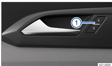
Fig. 44 En la puerta del conductor: tecla del cierre centralizado (representación esquemática).
