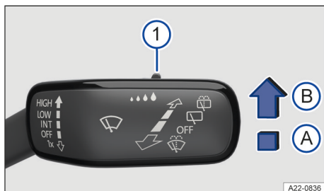
Fig. 72 En el lado derecho de la columna de dirección: palanca del limpiacristales.
