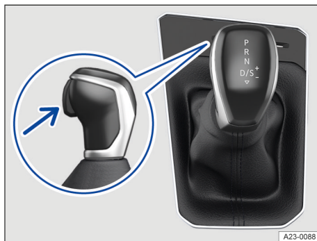
Fig. 84 En la consola central: palanca selectora de cambio automático (representación esquemática).
