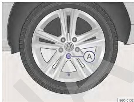
Fig. 162 Retire el tapacubos integral.
