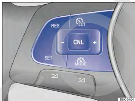
Fig. 100 Lado izquierdo del volante multifunción: teclas para comandar el GRA.
