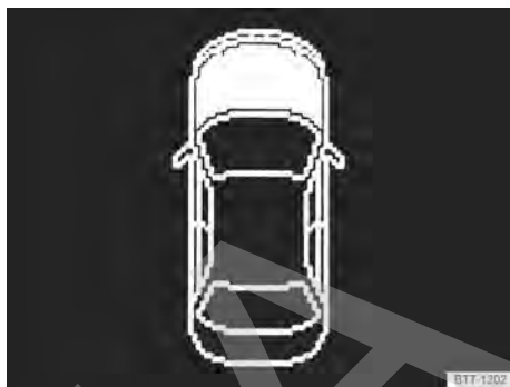
Fig. 147 En el display del instrumento combinado: tapa del compartimento del motor abierta o cerrada incorrectamente (representación esquemática).
