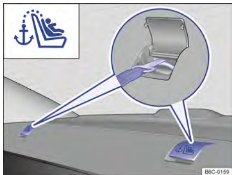
Fig. 45 Ojales de retención para el cinturón de fijación superior en la cubierta del maletero.
