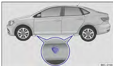
Fig. 166 Puntos de apoyo del gato.
