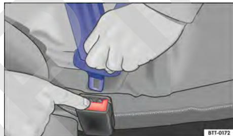
Fig. 32 Soltar la pestaña de encastre del cinturón de seguridad del cierre del cinturón.
