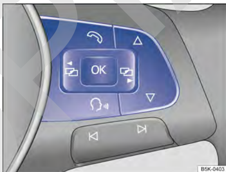
Fig. 22 Lado derecho del volante multifunción: botones para el mando de los menús y visualizaciones de información del instrumento combinado.
