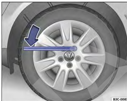
Fig. 164 Cambio de rueda: aflojar los tornillos de la rueda.
