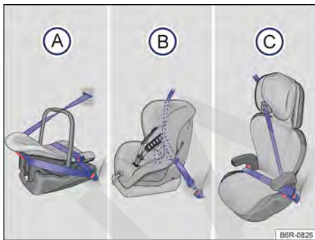
Fig. 42 Las ilustraciones A, B y C muestran la fijación del sistema de retención infantil sólo con el cinturón de seguridad del vehículo.
