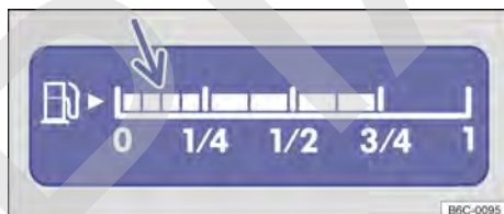
Fig. 13 En el display del instrumento combinado analógico: indicador del nivel de combustible (variante 1).
