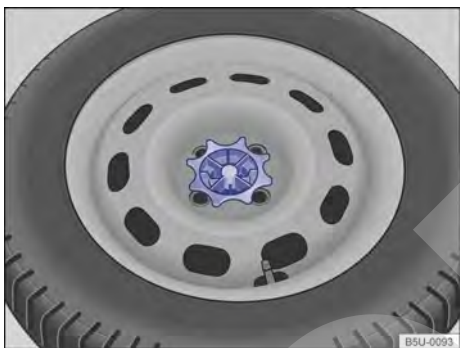
Fig. 160 En el maletero: manivela para fijación de la rueda de emergencia.
