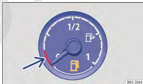
Fig. 14 En el instrumento combinado analógico: indicador del nivel de combustible (variante 2).
