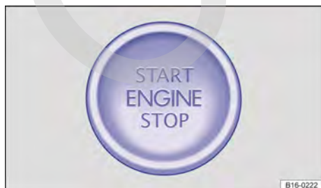
Fig. 91 En la parte inferior de la consola central: tecla de arranque para poner en marcha el motor
