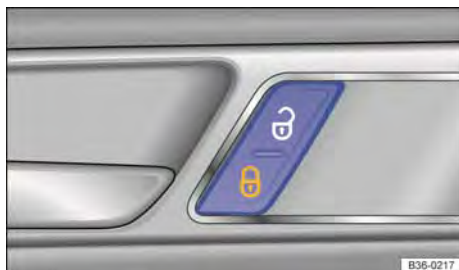
Fig. 53 En la puerta del conductor: tecla del cierre centralizado.
