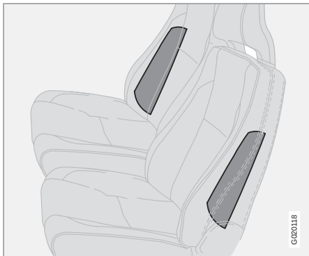
Colocación de airbags laterales.
