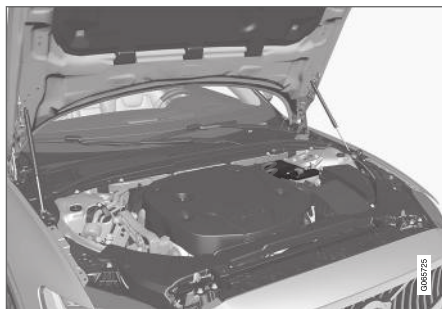
La batería de apoyo esta ubicada en el compartimento del motor.
