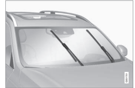
Escobillas de limpiaparabrisas en posición de servicio.
