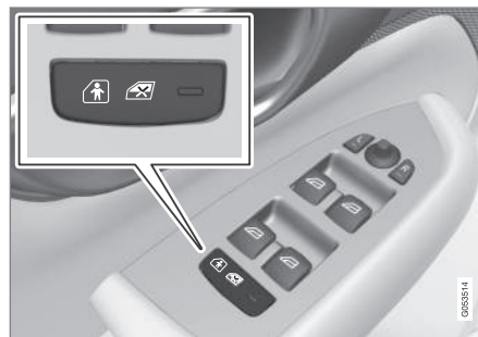
Botón de conexión y desconexión eléctrica.
