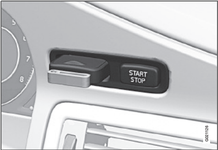
Cerradura de arranque con llave a distancia, interruptor de arranque/parada
