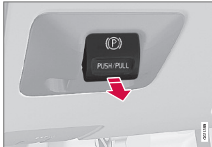
Mando del freno de estacionamiento
