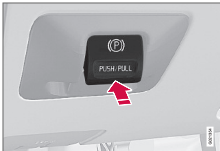
Mando del freno de estacionamiento
