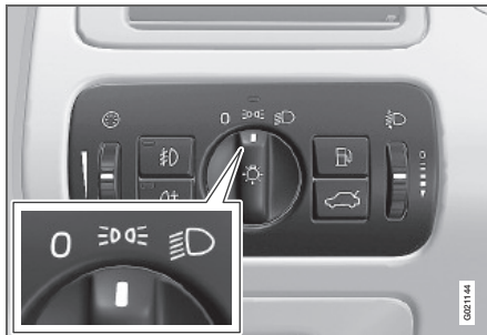
Mando en posición de luces de posición/luces de estacionamiento.
