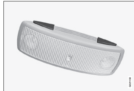
Iluminación trasera del techo
