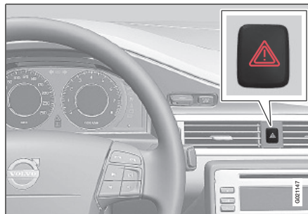
Luces de emergencia
