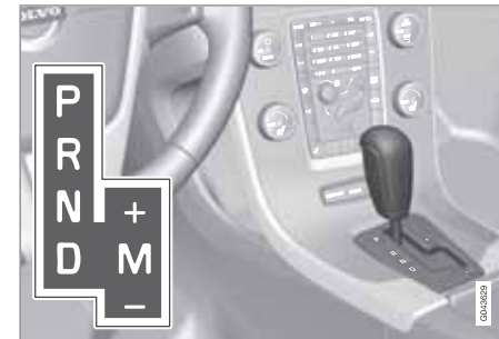
D: Cambios de marcha automáticos. M (+/-): Cambios de marcha manuales.
