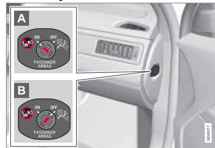
Ubicación del interruptor.
