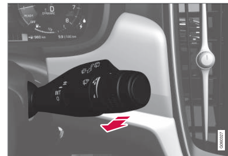
Función de lavado, palanca derecha del volante.
