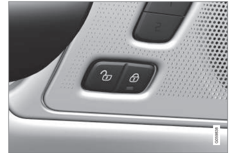
Botón de bloqueo y desbloqueo en la puerta delantera con luz de indicación.
