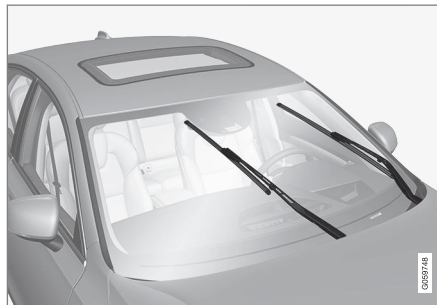
Escobillas de limpiaparabrisas en posición de servicio.
