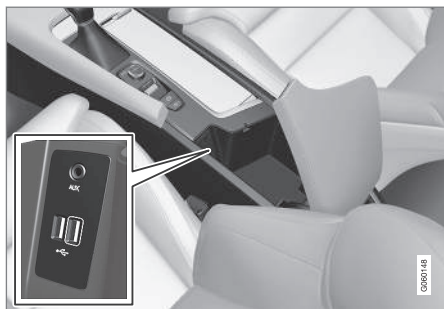
Conexión USB en la consola del túnel.
