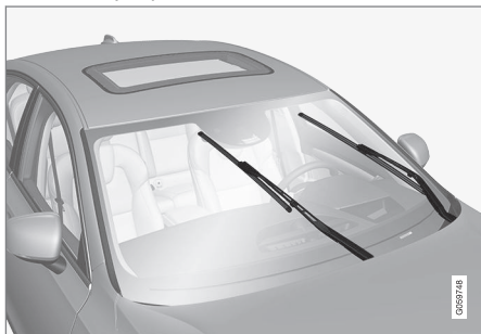
Escobillas de limpiaparabrisas en posición de servicio.
