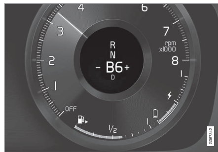
Vista general de la posición de freno en la pantalla del conductor.
