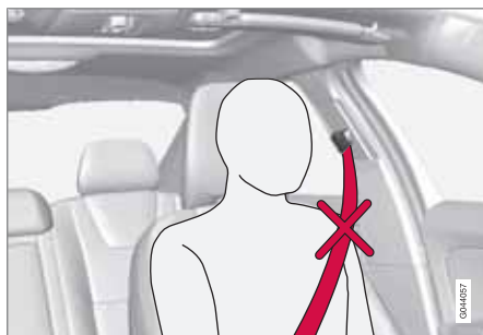
Cinturón de seguridad puesto de manera incorrecta. El cinturón debe ir sobre el hombro.
