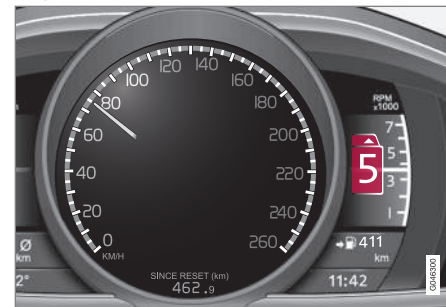
Cuadro de instrumentos "Digital" con indicador de cambio de marcha.
