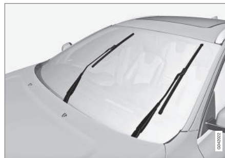
Escobillas de limpiaparabrisas en posición de servicio.
