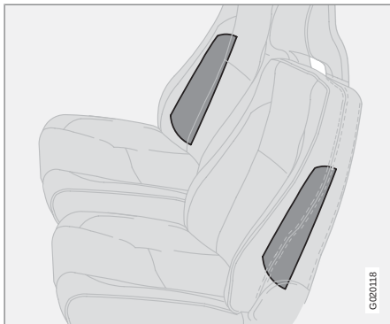
Colocación de airbags laterales.
