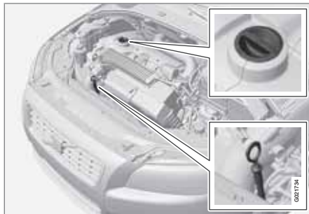
Varilla de nivel y tubo de llenado.
