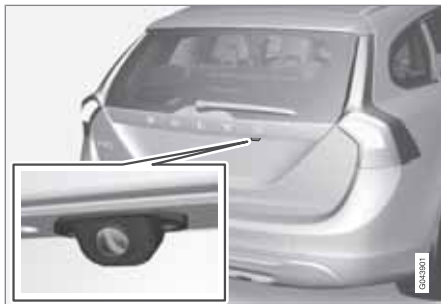
Ubicación de la cámara junto al tirador.
