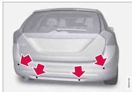
Ubicación de los sensores detrás.
