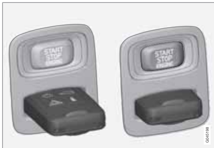
Contacto de encendido con mando a distancia extraído/introducido.
