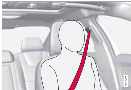
Cinturón de seguridad puesto de manera correcta.
