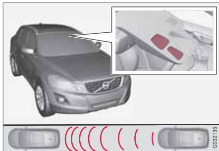
Ventanas del emisor y el receptor del sensor láser 1 .
