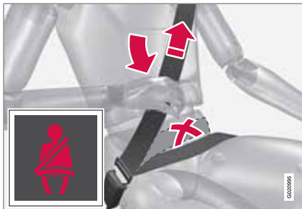
Cinturón de seguridad puesto de manera correcta.
