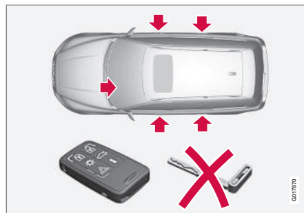
Puntos de cierre de la llave sin hoja extraíble y cierre de privacidad activado .
