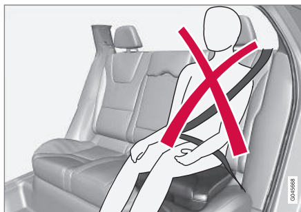
Posición incorrecta, el reposacabezas debe estar ajustado a la misma altura de la cabeza y el cinturón no debe ir debajo del hombro.
