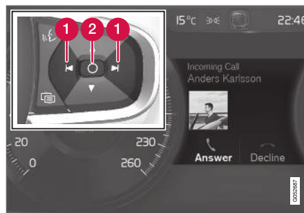
Ejemplo de mensaje en la pantalla del conductor 7 y teclado derecho del volante.
