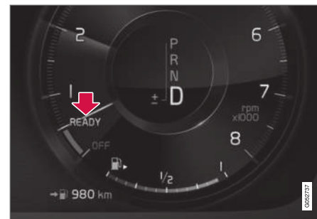
El sistema se ha activado y el motor se ha parado automáticamente.
