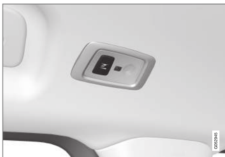
Los vehículos con techo panorámico* tienen dos unidades de luces, una a cada lado del techo.
