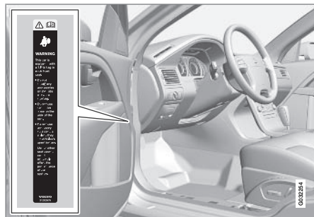
Placa de características del airbag lateral situada en el montante de la puerta.
