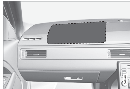
Ubicación del airbag del lado del acompañante en un vehículo con volante a la derecha.
