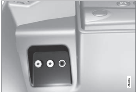
La entrada RSE-AUX está situada debajo del apoyabrazos delantero.
