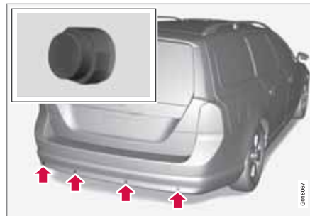
Ubicación de los sensores detrás.
