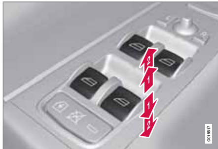
Accionamiento de los elevavinas eléctricos.
