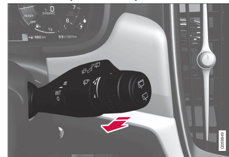
Función de lavado, palanca derecha del volante.
