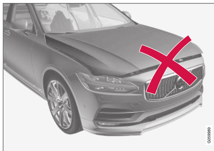
El capó no está completamente cerrado.
