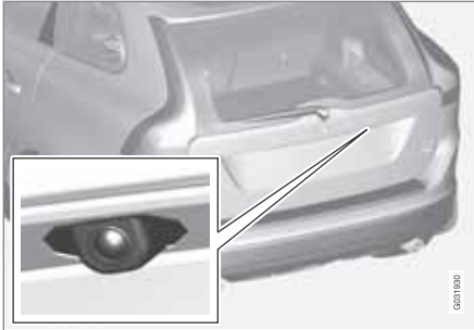
Ubicación de la cámara junto al tirador.
