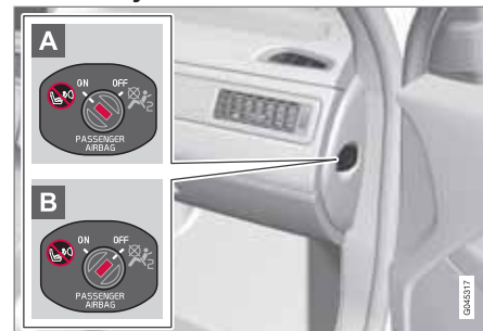
Ubicación del interruptor
