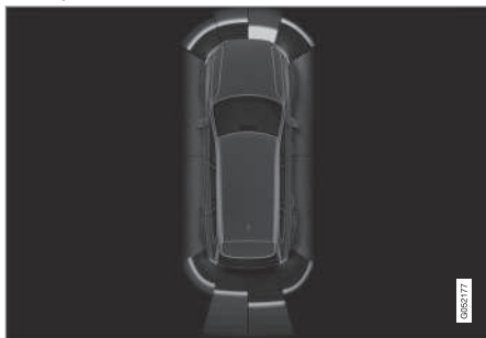
Vista de la pantalla con zonas de obstáculos y sectores de los sensores.
